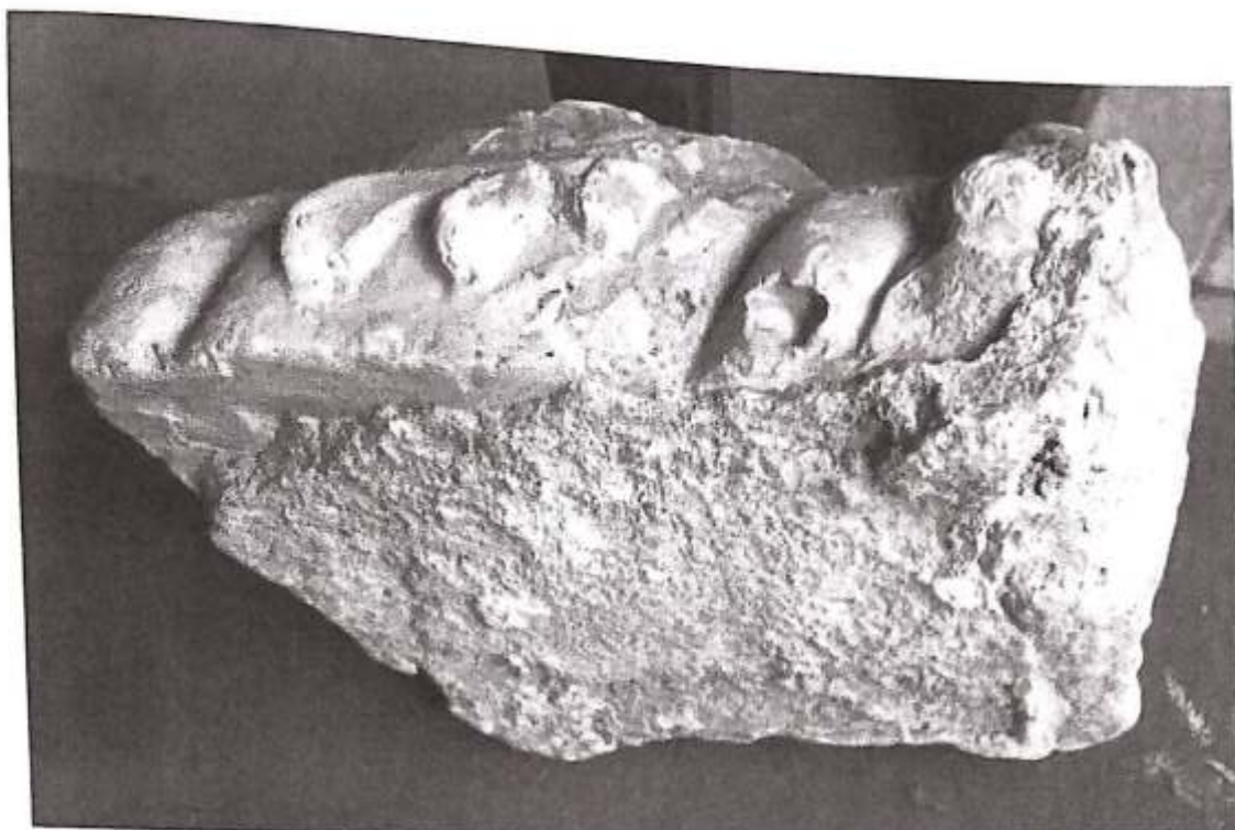
11. modul tăiat în unghi drept, "de capăt". Se vede un defect de turnare. Interiorul este umplut cu mortar de var.
