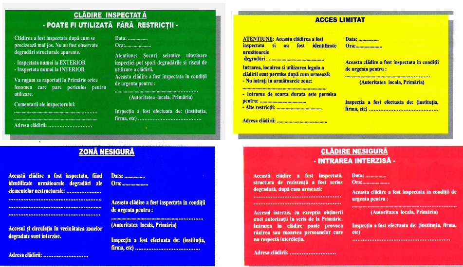
Fig. 10 . Placardele care se aplică după seisme pe clădiri ca urmare a inspecției stării acestora
