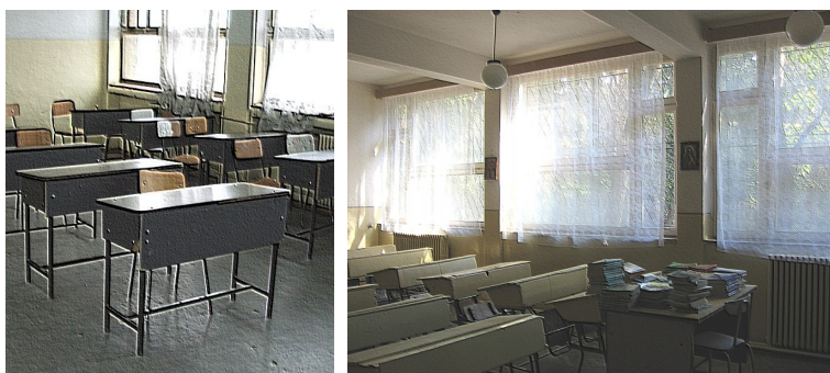
Fig. 8. Pupitrele obișnuite de clasă au schelet din oțel care împreună cu partea din produse lemnoase poate asigura protecția față de căderea unor lămpi, materiale didactice, tencuieli, geamuri
